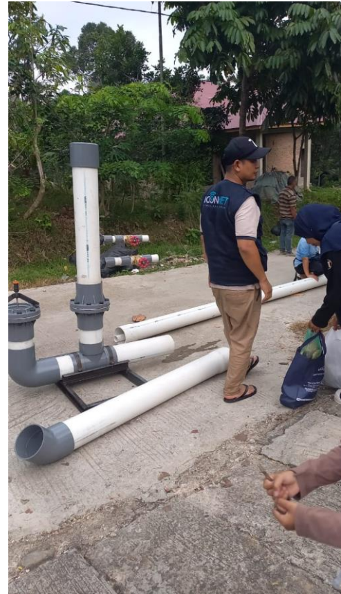
Gambar Alat Hydram pump dengan sistem monitoring berbasis IoT
